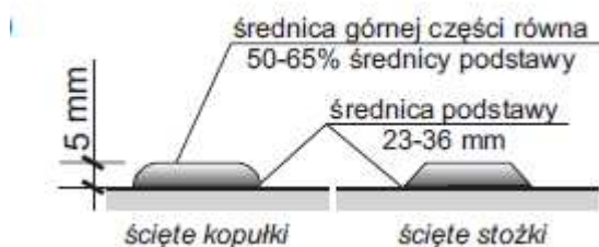
Rys 2b. Wymiary wypustek płytki ostrzegawczej na podstawie normy DIN 32984
