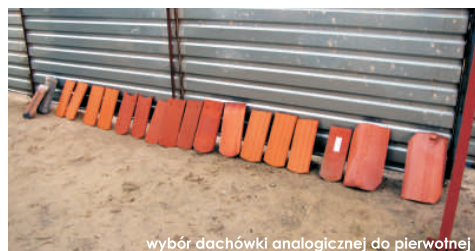
wybór dachówki analogicznej do pierwotnej
