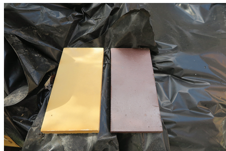
Płytki współczesne wykonane na wzór oryginalnych.
