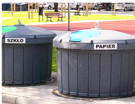
Rys. 38. Pojemniki częściowo podziemne (zdjęcie po lewej stronie) oraz niewywracalne pojemniki z samozamykającymi się klapami (zdjęcie po prawej stronie). Źródła: PPBin, Zarząd Zasobu Komunalnego we Wrocławiu.
